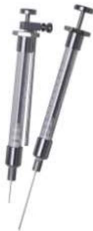
Шприц серии С идеально подходит для повседневного использования, обладает всеми стандартными характеристиками Pressure-Lok, такими как наконечник плунжера из PTFE, игла с уплотнением из PTFE и ультрагладкое отверстие, но без клапана для хранения образцов под давлением. Возможность хранения образцов может быть добавлена с помощью клапана шприца Mininert.
